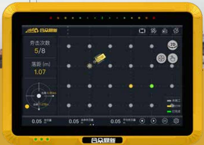
采用北斗高精度定位技术，结合各类传感器，在施工过程中对夯击遍数、夯锤落距、夯点坐标、夯沉量变化等进行记录，并对数据存储、上传及分析，业主、监理、施工单位等工程各参与方都可以通过数字化施工管理平台实时进行信息共享，及时掌握施工质量、施工进度、工程计量等。施工过程和结果数据真实有效，协助及时发现问题并纠偏处理，并可作为工程验收的辅助手段之一。系统广泛应用于机场、港口、填海造田等软基处理工程。
