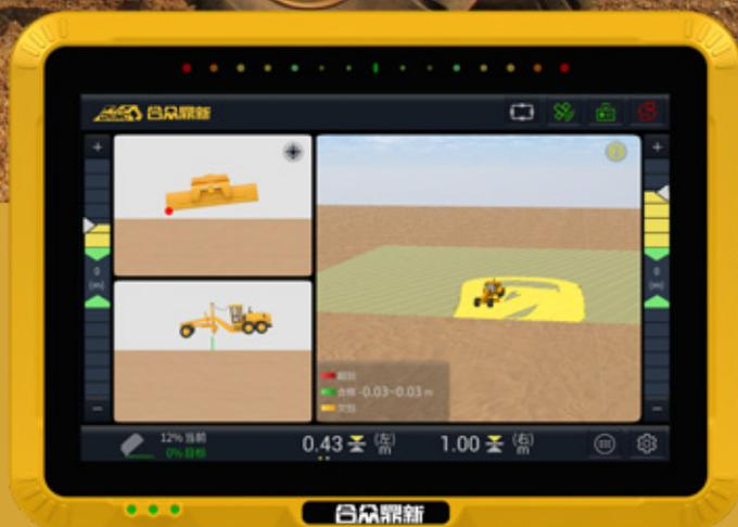
UGS 平地机智能系统采用北斗高精度实时动态定位技术，经过读取安装在刮刀等部位上的各种传感器，解算校准过的主要枢轴尺寸，获得刮刀实时、精确的三维位置信息，即使在视力不及的盲区，也能辅助机手精准工作，彻底改变了人们对于平地机传统施工方式的认知，引导操作手精确施工。
